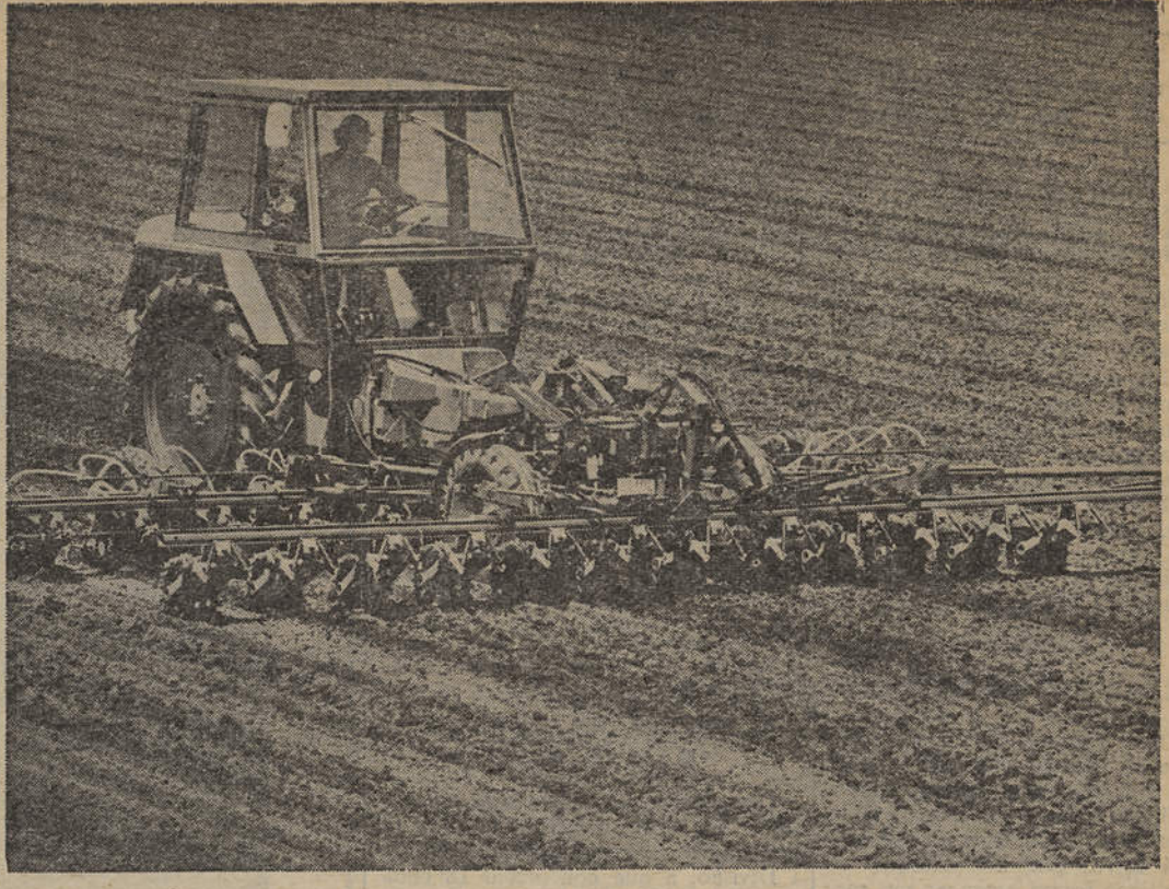
Uma agricultura moderna e produtiva necessita de boas máquinas que ofereçam condições de segurança aos condutores. O rebocador «F 275 GT» de Marktoberdorf, RFA, aqui apetrechado com um arado frontal de seis metros de largura, um aparelho desemeador com doze filas e um pulverizador, desenvolve uma potência de 70 cavalos-vapor e dispõe de uma cabina de motorista à prova de som e vibrações. O envidraçado, com 4,7 m 2 , oferece um amplo panorama e possui um sistema especial de lavagem. O assento adapta ao peso e altura do motorista.
