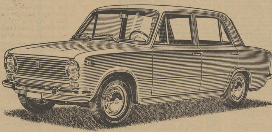
65 CV (SAE), MAIS DE 140 Km/h, TRAVÕES DE DISCO AS 4 RODAS, ALAVANCA DE MUDANÇAS NO VOLANTE, 4 PORTAS, 5 LUGARES.
