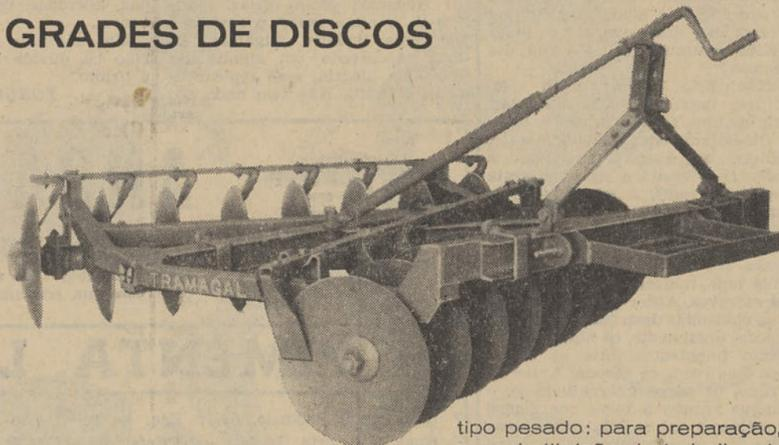
tipo pesado: para preparação, complemento ou substituição do trabalho de charruas. tipo montado: para mobilização do solo e a cobertura de sementes e adubo.
