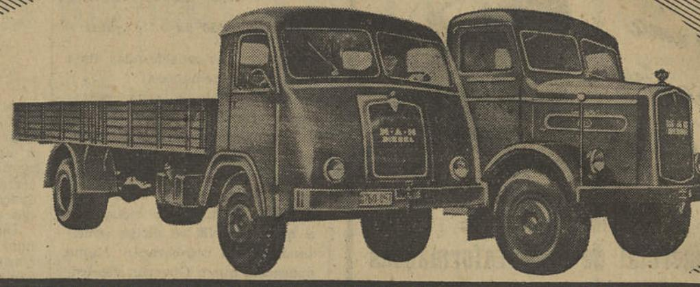
CABINE AVANÇADA PARA CARGAS LEVES • P. B. 15.000 KS • CABINE NORMAL PARA CARGAS CONCENTRADAS
